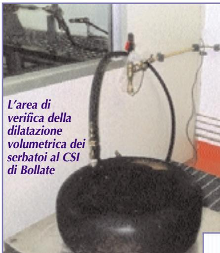
L'area di verifica della dilatazione volumetrica dei serbatoi al CSI di Bollate
