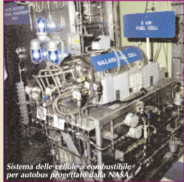
Sistema delle cellule a combustibile per autobus progettato dalla NASA
